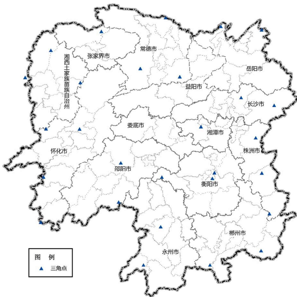
图 1-2 GPS 大地控制网分布图
